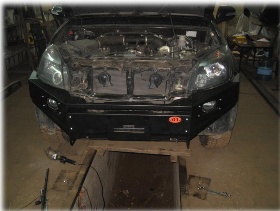
Вид установленного бампера.
