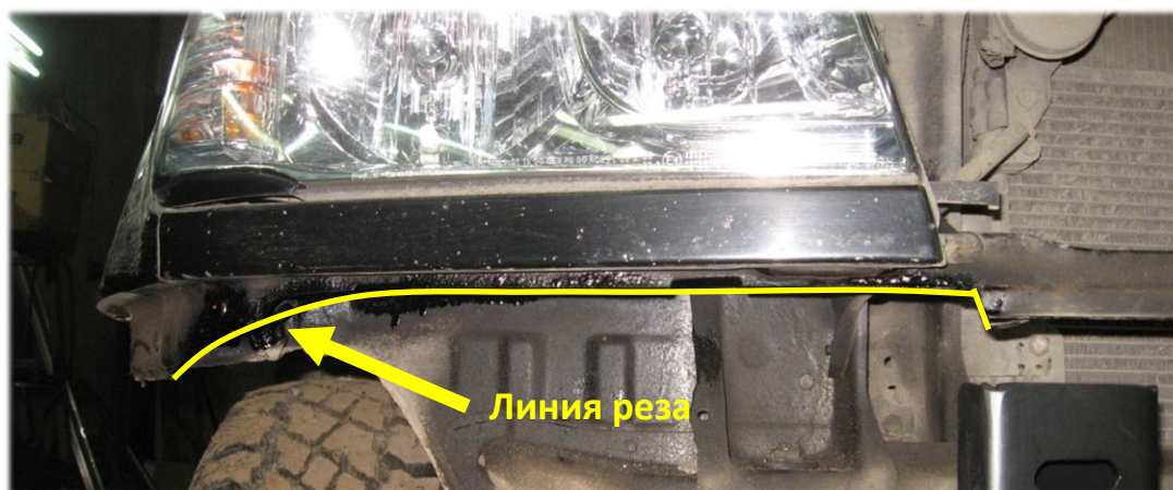
Итоговый вид кузова, подготовленного к установке бампера.
